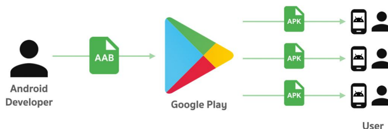
Obrázek 3.1: Obrázek znázorňující cestu sestaveného balíčku aplikace od vývojáře k uživateli. Vývojář vytvoří AAB balíček, který je umístěn na platformu Google Play. Z té uživatel stáhne APK balíček obsahující zkompilovaný kód a zdroje přizpůsobené na dané zařízení. Obrázek byl převzat z [14].
