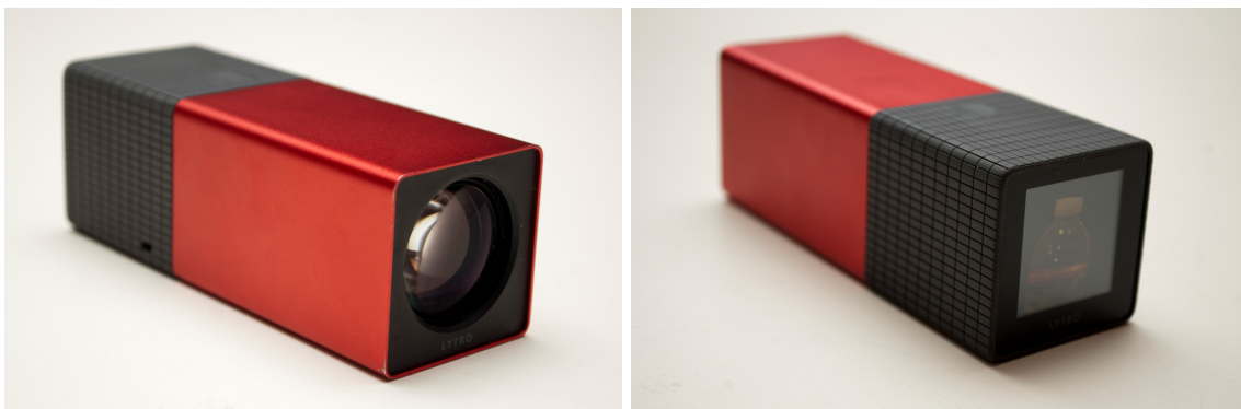
Obrázek 2.11: Kamera od společnosti Lytro, Inc. umožňující zachytit fotografii jako plenotickou funkci. Fotoaparát je vybaven maticí čoček a speciálním senzorem určeným právě ke snímání light fieldu 3 .
