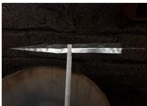
(f) Po úspešnom vytvorení ostria meča je schladený a môže sa použiť na zloženie meča
