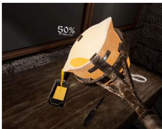
(b) Tekutý kov sa leje do väčšej formy v tvare tehličky
