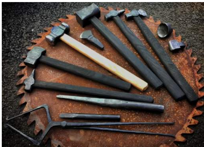
Obr. 4.3: Prehľad kováčskych kladív a nástrojov určených pre deformáciu kovov 1 . V strede kladivo s oblou časťou na jednej strane a plochou na druhej.
