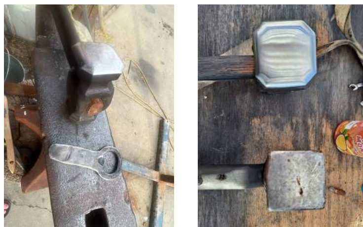
Obr. 6.8: Vľavo detail na hlavu plochého kladiva určeného na vyhladzovanie povrchu, vpravo porovnanie starého a nového moderného kladiva 1
