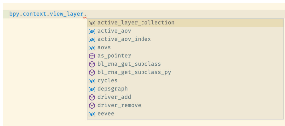
Obrázek 5.3: Automatické dopĺňanie kódu vo VS Code pomocou python balíčka fake-bpy-module .
