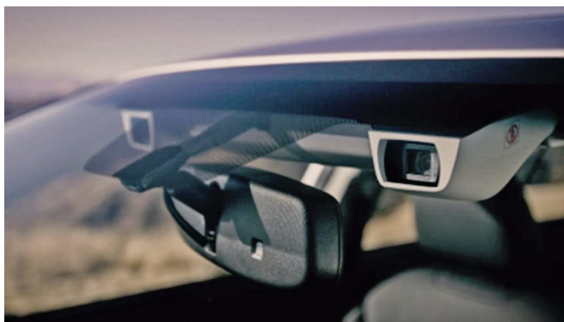
Obr. 2.6: Ukážka umiestnenia stereo kamery pod čelným oknom vozidla 5
