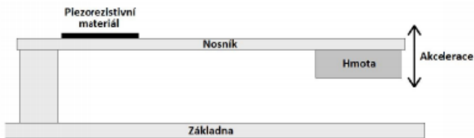
Obrázek 2.11: Princip piezorezistivního akcelerometru
