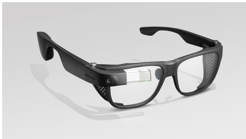
Obrázek 2.5: Google Glass Enterprise Edition 2, chytré brýle s malým displejem.
