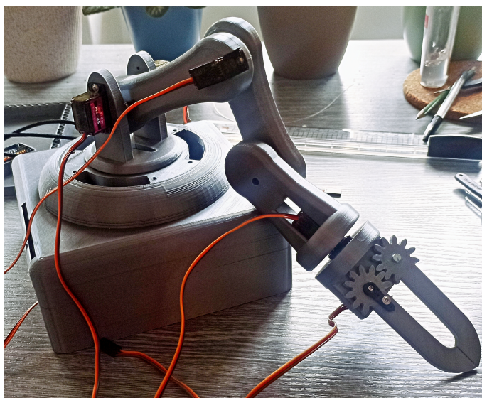
Obrázek 5.7: Model robotické paže vytisknuté na 3D tiskárně na němž jsou upevněné servomotory.
