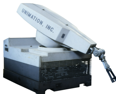
Obrázek 2.1: Unimate robot - první průmyslový robot (1. generace) 1 .
