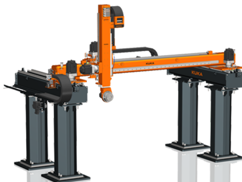
Obrázek 2.10: Robot Kuka využívající translačního pohybu 14 .
