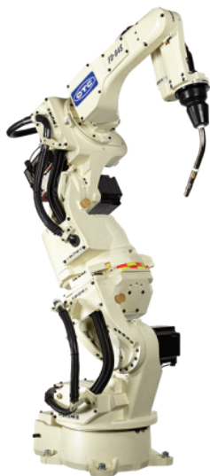
Obrázek 2.2: FD-B4LS od firmy OTC Daihen (2. generace) 2 .
