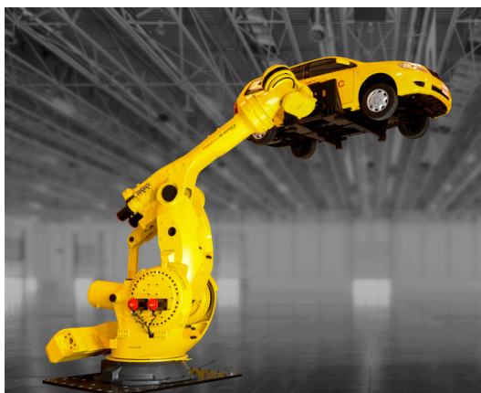
Obrázek 2.9: Robot Fanuc M-2000iA/2300 se schopností uzvednout až 2,3 tuny 12 .
