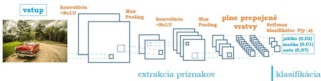
Obr. 2.9: Príklad vrstiev konvolučnej neurónovej siete (zdroj: [26])
