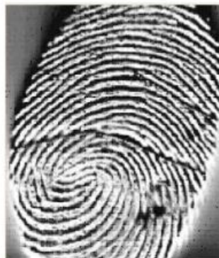
Obr. 3.12: Vlas na povrchu snímača. Prevzaté z: [27].
