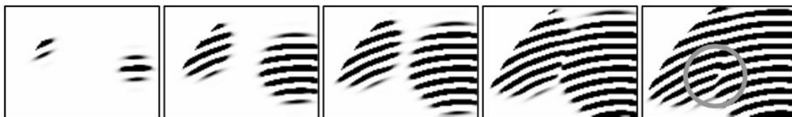
Obr. 2.10: Ukážka tvorby markantu počas splynutia dvoch regiónov tvorených z dvoch rôznych počiatočných bodov. Prevzaté z: [29].
