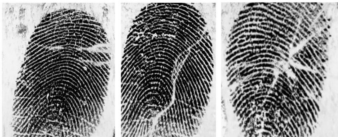
Obr. 4.14: Vzory poškodeného skla vytlačené na priesvitnú fóliu a priložené medzi prst a snímač.
