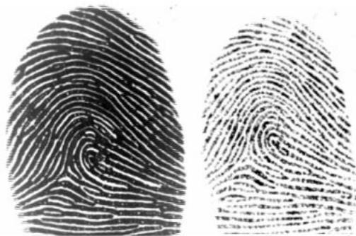
Obr. 3.10: Vlhký prst (naľavo) a príliš suchý prst (napravo). Prevzaté z: [30].
