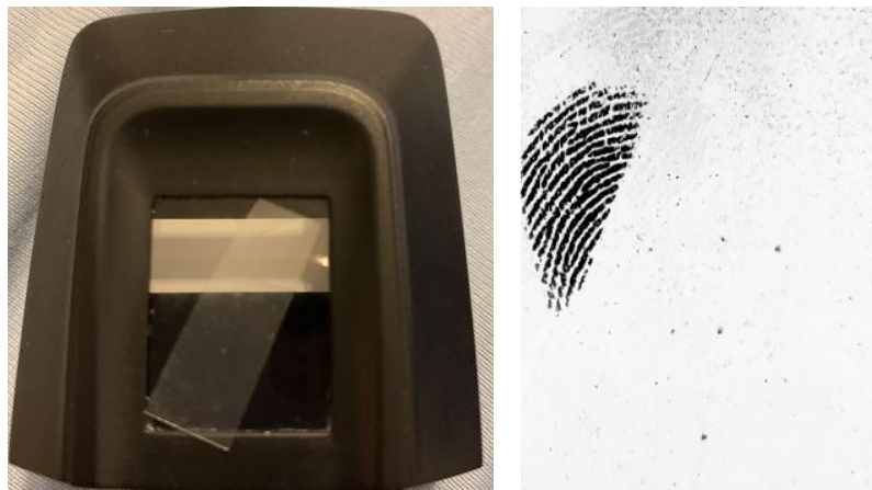
Obr. 4.13: Priloženie tenkého sklíčka medzi snímač a prst. Zatiaľ čo časť prsta, ktorá neleží na sklíčku, je zachytená, časť odlačky v oblasti sklíčka vidno nie je. Výsledná snímka je dôkazom, že tenké priehľadné sklíčko zabráni snímaniu odlačky prsta.
