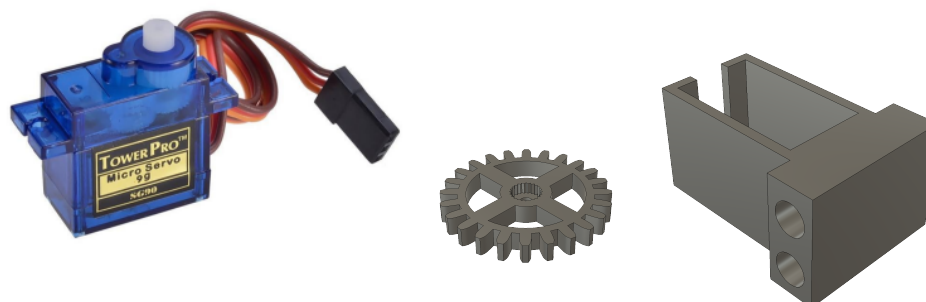
Obr. 4.3: Analógové 9g micro servo 5 a návrhy dielov pre zabezpečenie kompatibility so stavebnicou LEGO.
