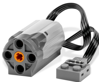
Obr. 4.2: Jednosmerný motor LEGO M 8883 poháňajúci model vozidla 3
