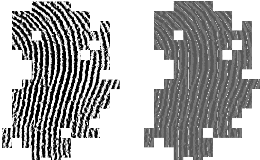
Obrázek 6.3: Segmentace a pole orientací otisku z obrázku 6.2. Nalevo: segmentovaný otisk, napravo: vyznačené pole orientací.
