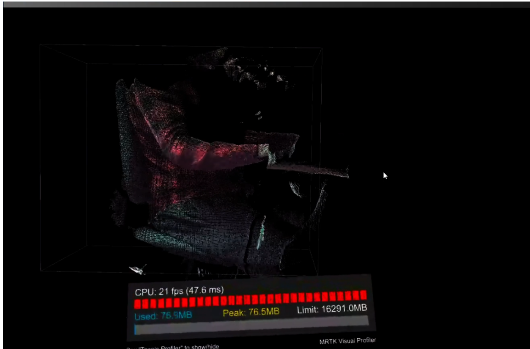
Obrázek 7.1: Vizualizace mračna bodů v simulátoru Microsoft HoloLens 2 s aktivovaným měřením VisualProfiler .
