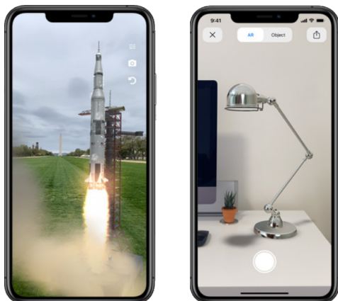
Obrázek 2.3: Ruční zobrazovací zařízení pro rozšířenou realitu – mobilní telefon. V levé části obrázku je zobrazena virtuální raketa, která je umístěna v reálném prostředí. V pravé části obrázku je virtuální lampa umístěna na stůl v reálném prostředí.
