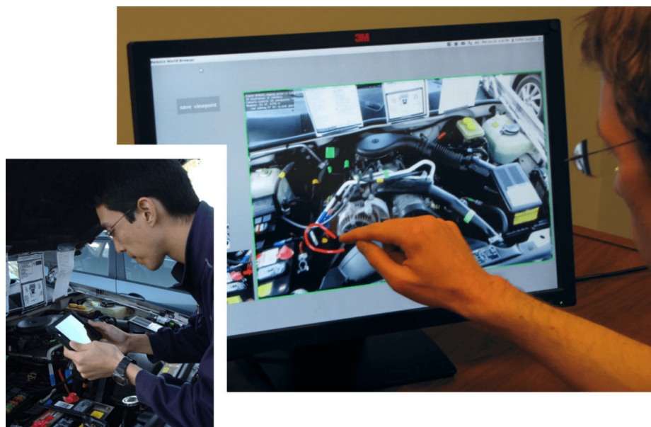
Obrázek 2.12: Kolaborativní uživatelské rozhraní. Vzdálený uživatel (vpravo) označí prvek v prostředí tím, že kolem něj nakreslí obrys. Anotace je registrována v prostoru a zobrazena na tabletu v rozšířené realitě lokálního uživatele (vlevo) [13].
