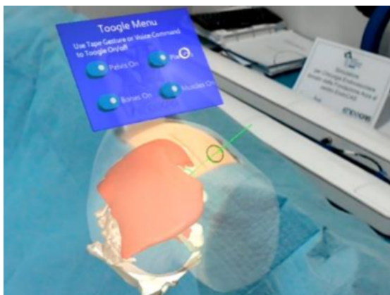
Obrázek 2.6: Simulátor artroplastiky kyčelního kloubu. Snímek zobrazuje virtuální anatomii kyčelního kloubu v brýlích Microsoft HoloLens [45].
