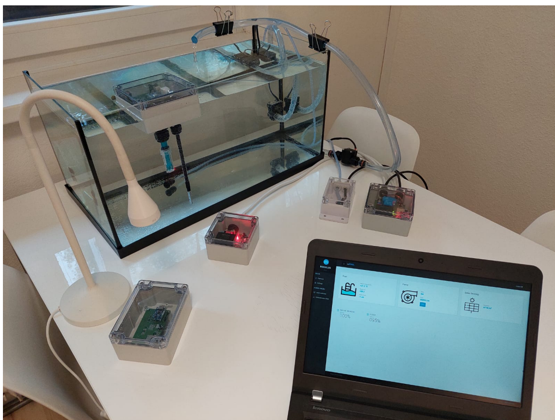
Obrázek 7.1: Ukázka testování kompletního systému.
