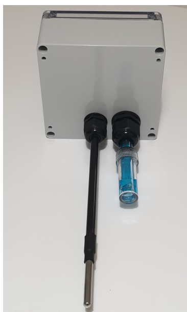
Obrázek 6.2: Ukázka prostupu senzoru teploty a pH sondy stěnou krabičky u plovacího modulu.
