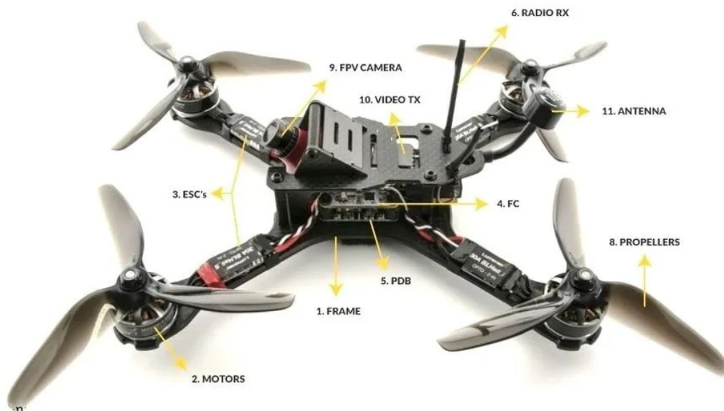
Obr. 2.1: Popísaná základná stavba dronu 1
