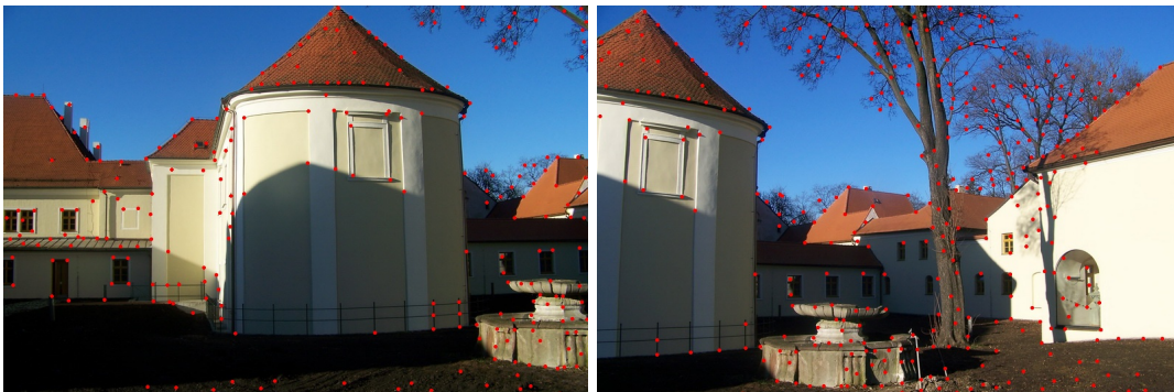
Obrázek 3.4: Detekované rohy ve dvou obrázcích (247 resp. 390 bodů)
