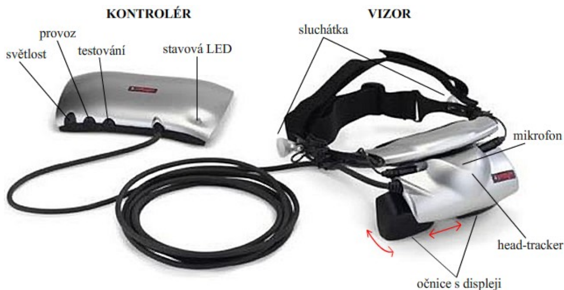
Obrázek 20: Popis zařízení 3D vizor Z800. Šipky značí možné nastavení rozestupu očnic a jejich sklonu.
