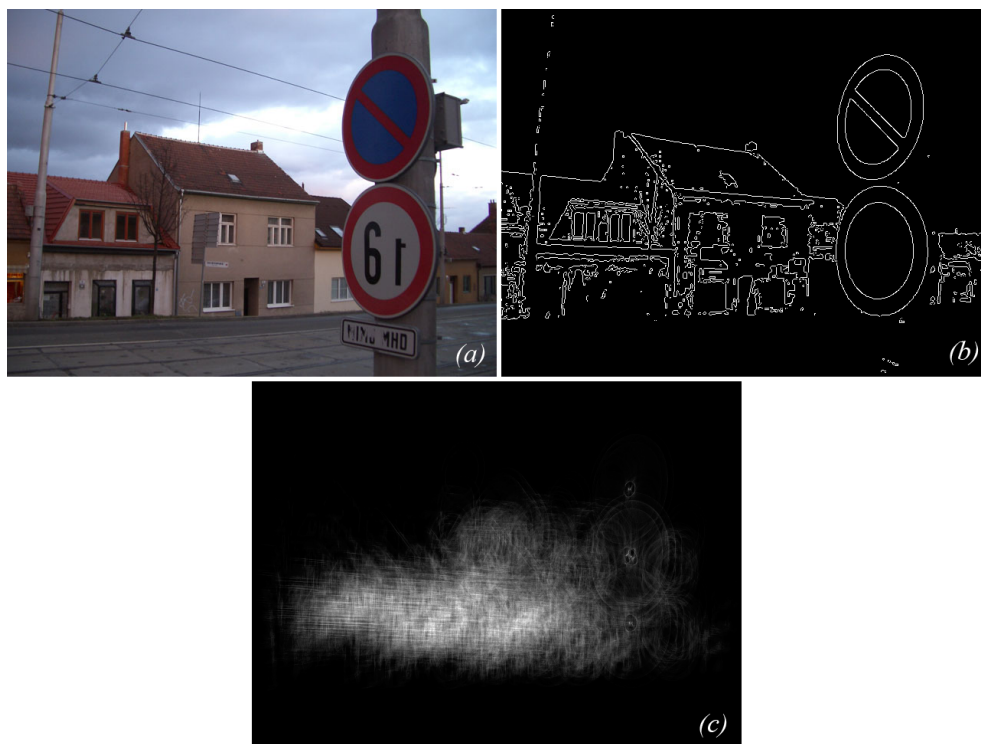
Obrázek 3.1: Detekce středu elipsy dle původního algoritmu Modifikovaná Houghova transformace (podkapitola 2.2). (a) Původní obraz. (b) Hrany původního obrazu na výšce červené barvy a jejího okolí. (c) Normovaný histogram akumulovaných pozic středů úseček mezi body hran.
