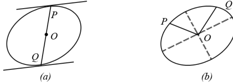
Obrázek 2.1: (a) OP = OQ , pokud jsou dvě tečny rovnoběžné. (b) 1/|OP|^2 + 1/|OQ|^2 = 1/|R|^2 = konstanta , pro elipsu pokud \angle POQ = 90^\circ .
