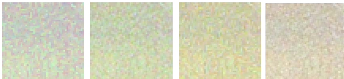
Obrázek 26: Šum ve výsledném obraze vytvořeném metodou Pixel Grouping, vylepšenou lineární metodou, metodou AHD a aplikace navrhované metody pro potlačení šumu
