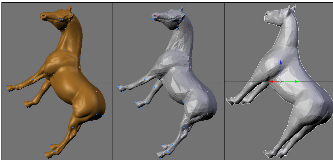
Obrázek 5.12: Test zpracování modelů s velmi vysokým počtem polygonů. Referenční model je vyobrazen v levé části obrázku, zdrojový model v pravé části a nedokončený model uprostřed.
