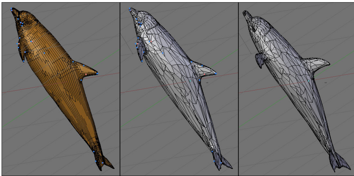
Obrázek 5.11: Test zpracování modelů delfínů. Referenční model je zachycen vlevo, zdrojový model vpravo, finální model uprostřed.
