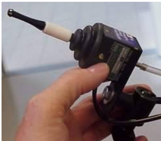
Obr. 4.3.1 – joystick, který se ovládá ústy
