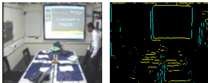
Obrázek 3.2 obraz po aplikaci Box Blur filtru (vlevo) a po aplikaci Sobelova hranového operátoru (vpravo), modře jsou vyznačeny vertikální, žlutě horizontální hrany
