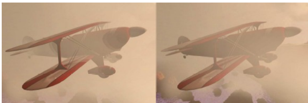
Ilustrace 6.5: Letadlo v mracích, vlevo je přímo vyrenderovaný obrázek s viditelnými artefakty. Vpravo s použitím dělených impostorů, které tento artefakt odstraňují.
