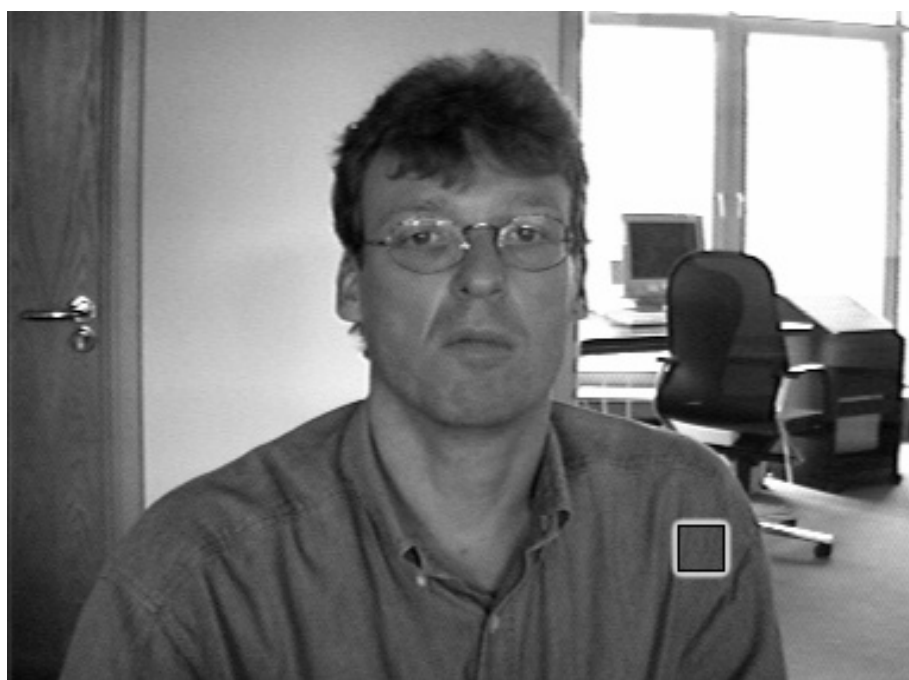
obr. 5.3 ukázka nedetekovaného obličeje a jediné falešné detekce
