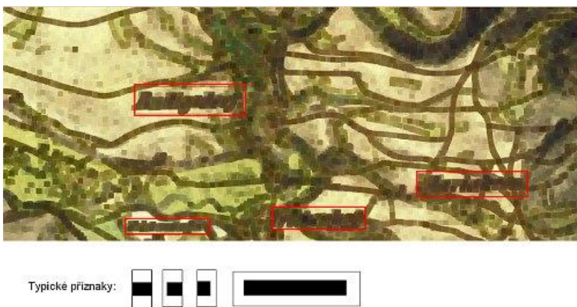
Obrázek 5.9: Obrázek popisuje návrh úpravy testovací sady. V horní části obrázku je erozí upravený obraz a ve spodní jsou pravděpodobné typy příznaků použité pro detekci. Červené obdelníky na obrázku označují pozici textu na mapě.
