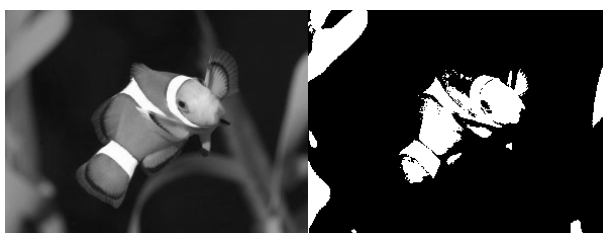
Obrázek 3.3: Příklad převodu obrázku o 256 stupních šedé na obrázek černobílý pomocí prahování.
