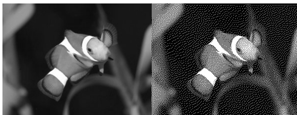
Obrázek 3.5: Příklad převodu obrázku o 256 stupních šedé na obrázek černobílý pomocí metody distribuce chyby. Konkrétně metoda Floyd-Steinberg.
