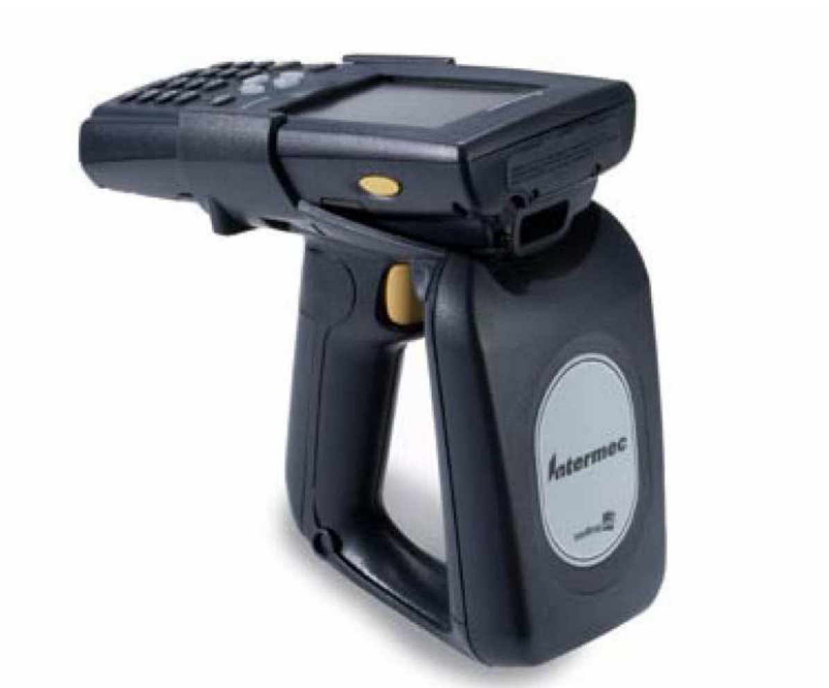
Obrázek 3.1 Vybrané zařízení s externí čtečkou RFID tagů.
