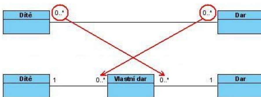
obrázek 3 – Ukázka odstranění vztahu s kardinalitou N:M
