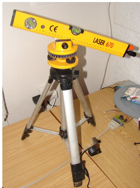
Obr. 30 Laserový zdroj s optickým vytvořením linky
