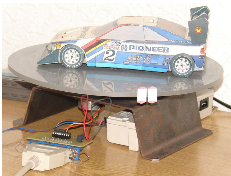
Obr. 29 Otočný podstavec pro umístění snímaného objektu.
