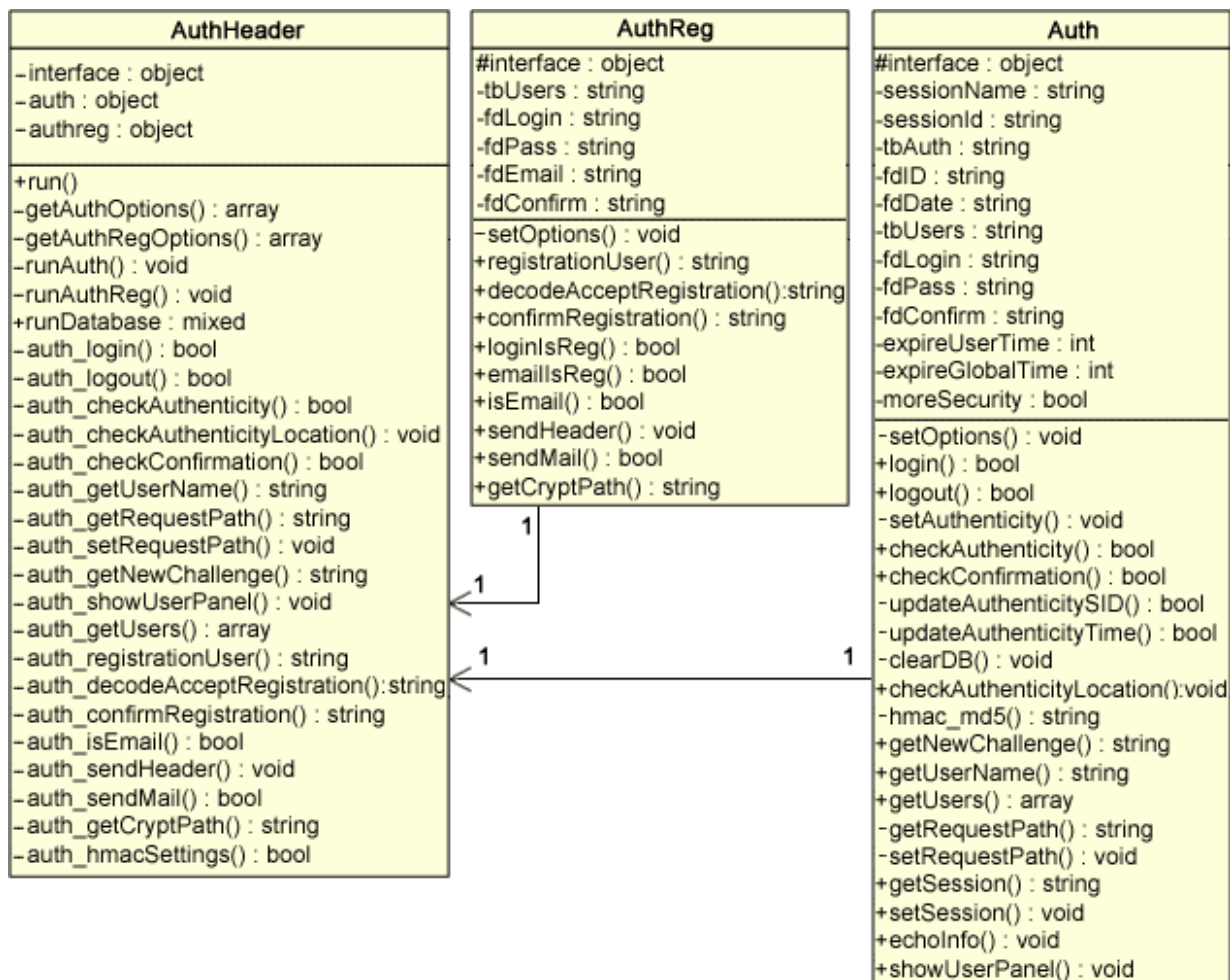
Obrázek 5.8: Diagram tříd modulu Auth
