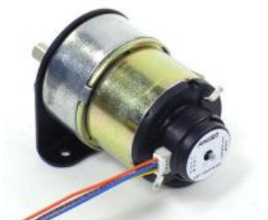
Obrázek 2.5: Optický enkodér QME-01 na motorku GHM-04 [10]
