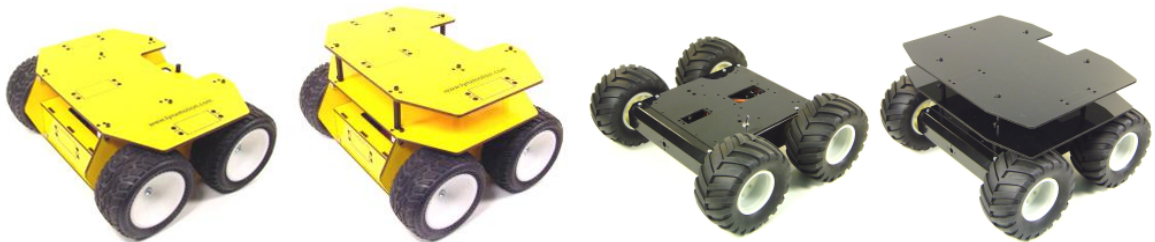
Obrázek 2.1: Lynxmotion 4WD1 a A4WD1 bez horní plošiny a s horní plošinou
