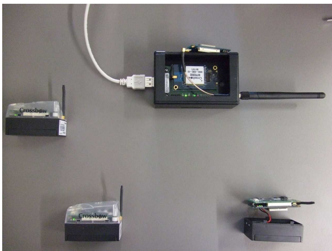
Obrázek A.1: Ukázka vytvořené bezdrátové sítě pro praktické ověření funkčnosti Dissemination protokolu
