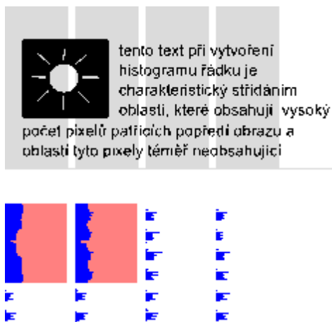
Obrázek 5.2: Rozlišení oblastí obrázku a textu pomocí histogramů částí obrazu
