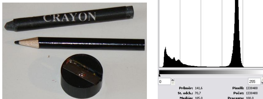
Obrázek 3.1: Vhodný obrázek pro globální prahování a jeho histogram intenzit jasu pixelů
