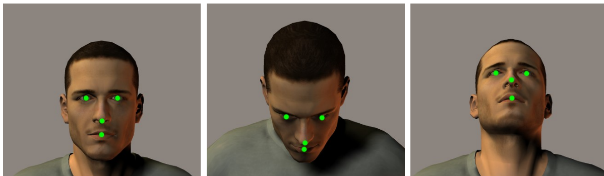
Obr. 4.5: Ukázka změny vzájemné pozice bodů v závislosti na náklonu hlavy
