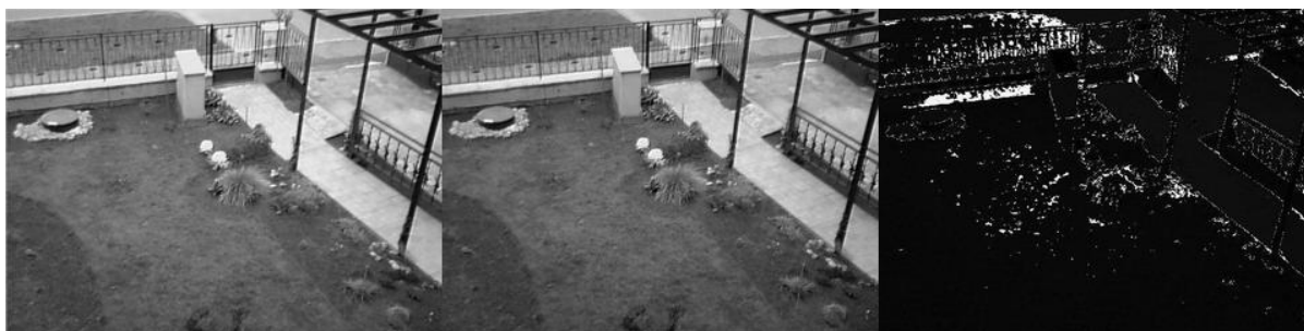
(Obrázek 4) Porovnání jasu pixelů dvou snímků
