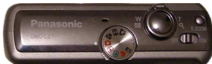
Obrázek 4.1: ovládací prvky - horní strana
