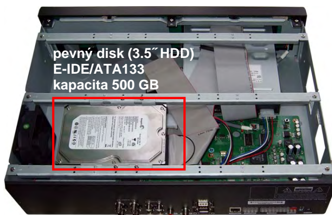
Obrázek 7.17: Instalace HDD do videorekordéru
