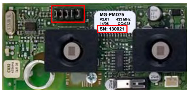
Obrázek 7.4: Jumpery a sériové číslo na desce bezdrátového detektoru
