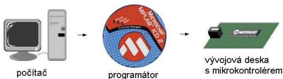
Obr. 13: Příklad zapojení zařízení při procesu programování mikrokontroléru.
