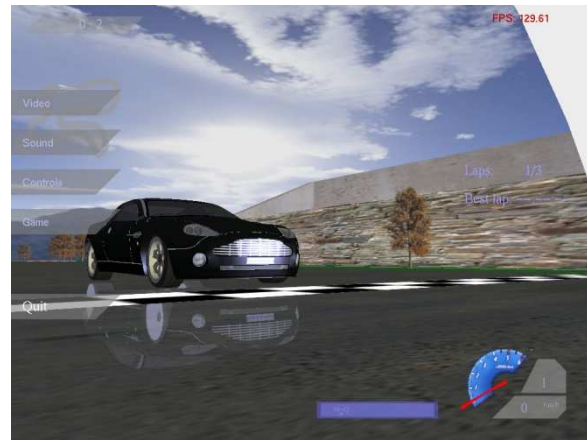
Obrázek 5.10: Využití stencil bufferu k zobrazení odrazu šablony
