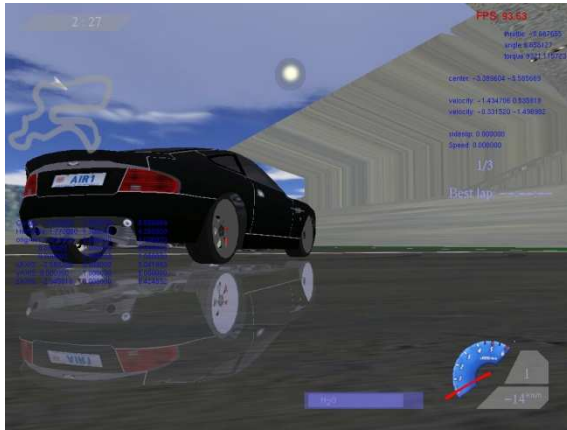
Obrázek 5.10: Využití stencil bufferu k zobrazení odrazu šablony
