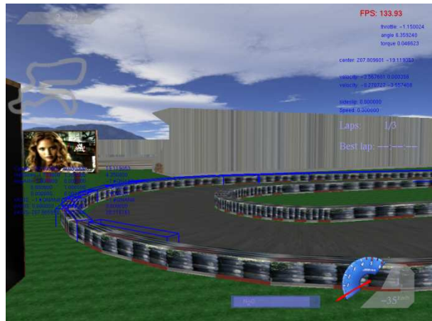
Obrázek 5.16: Objekty dráhy obalené kolizními boxy
