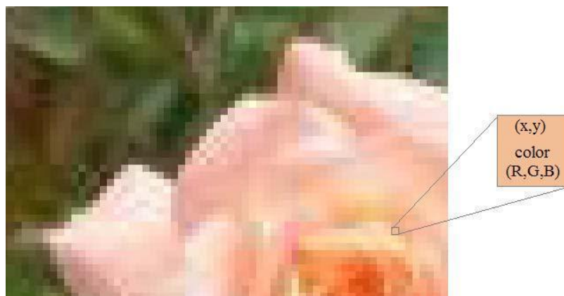
obr 2.2 jednotlivé pixely, ze kterých se celý obraz skládá.
