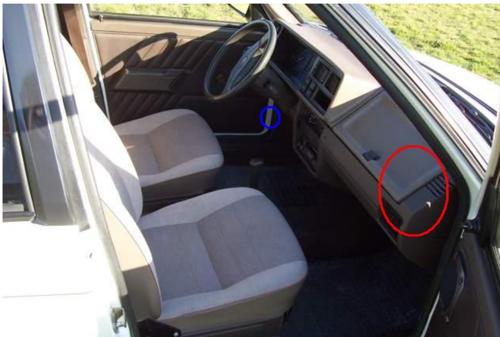
Obrázek 5.13: Umístění jednotky (červená elipsa) a dveřního spínače (modrá elipsa)
