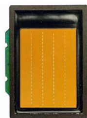
Obrázek 4.4: Kapacitní snímač otisků prstů [37]
